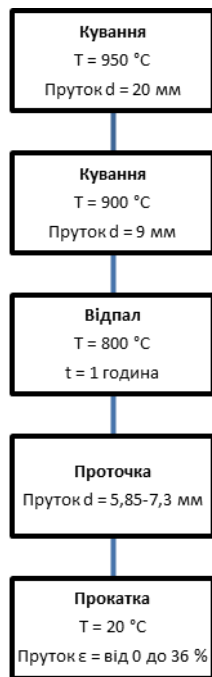
Рис. 3.2. Схема виготовлення прутків при холодній деформації
