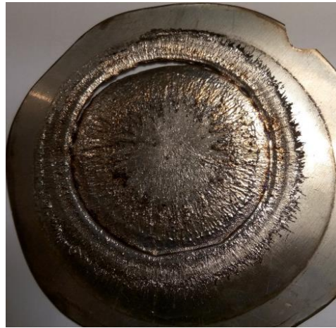
Рис. 3.1. Відбиток трубчастого РЕП на конвертері з нержавіючої сталі
