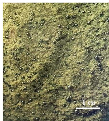
Рис. 2. Зовнішній вигляд (а) та структура зразків з ІОС (б), отриманих з використанням термообробки під тиском (80 °С)
