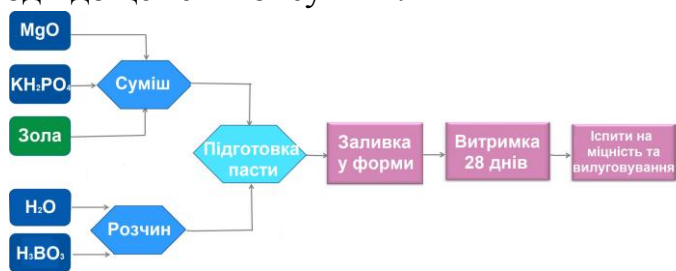
Рис. Схема виготовлення МКФ компаунду та зовнішній вигляд отриманих зразків ( 3 \times 3 \times 3 см).
