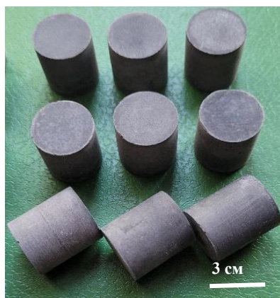
Рис. 2. Зовнішній вигляд (а) та структура зразків з ІОС (б), отриманих з використанням термообробки під тиском (80 °С)
