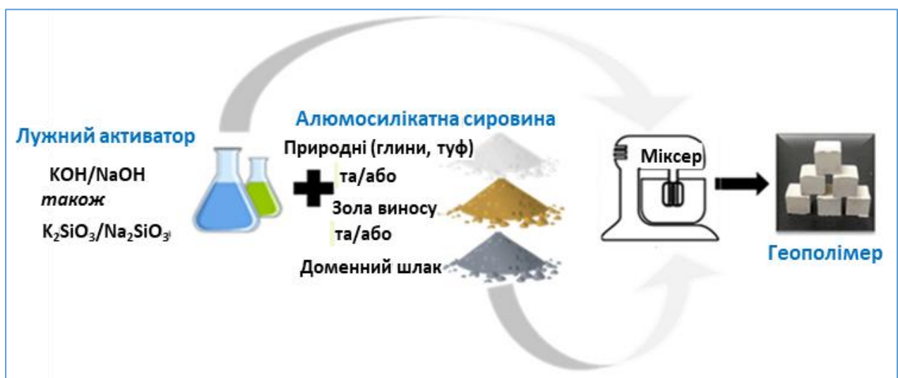
Рис. 1. Геополімер: сировина та схема отримання
